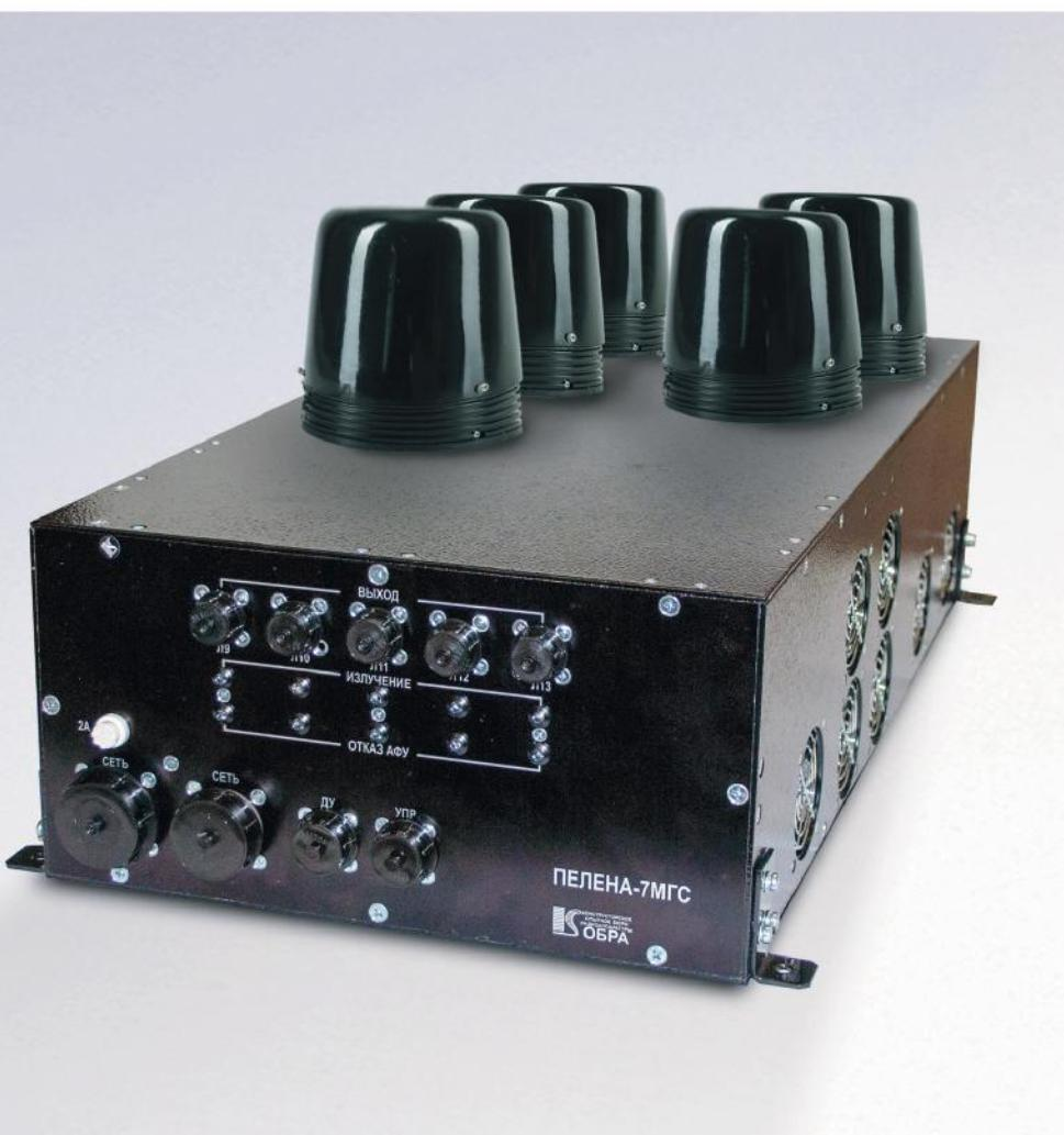
Изделие предназначено для защиты пассажиров автомобиля от несанкционированного прослушивания с помощью специальных радиоустройств и предотвращения срабатывания радиоуправляемых взрывных устройств вследствие противодействия каналам управления. Используется в условиях, когда необходимо подавление сигналов мощности в диапазоне частот сотовой связи.
