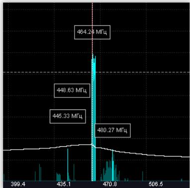
Перемещение по списку частот обеспечивает автоматическую установку курсорной линии на данной частоте в окнах «Весь диапазон» и «Полоса»
