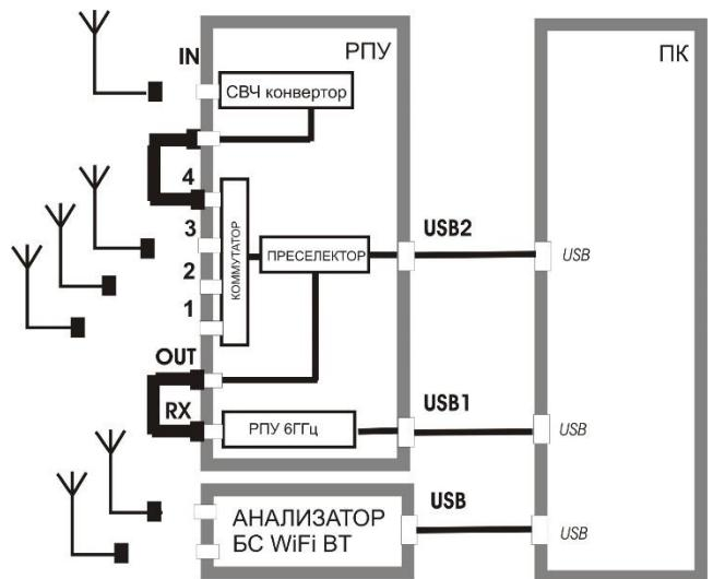
Соединение модулей РПУ осуществляется посредством входящих в комплект соединительных коаксиальных кабелей. На рисунке показана сборка в максимальной конфигурации.
