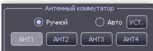
При выборе автоматического режима **(Авто)** обеспечивается автоматическое последовательное подключение входных разъемов в зависимости от частотного диапазона, задаваемого в окне установок. Доступ к данному окну обеспечивается нажатием на кнопку «**УСТ.**».
