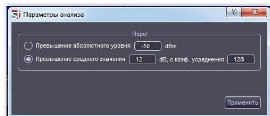
**Превышение среднего значения XX дБ, с коэф. усреднения YYY** - выбор ломаной пороговой линии, превышающей шаблон на XX дБ. Выбрано по умолчанию. Данный вариант эффективен при достаточно резком перепаде уровней сигналов – например, при анализе во всем диапазоне частот.
