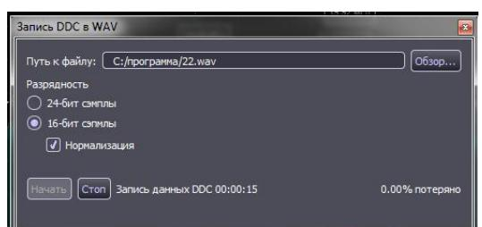
16 бит из исходных 24 бит данных. Предусмотрен режим нормализации данных при записи. В этом случае, система будет работать аналогично системе с АРУ (автоматическая регулировка усиления), т.е. будет преобразовывать сигнал по амплитуде для записи в WAV файл таким образом, чтобы доступная разрядность (16 или 24 бита) использовалась максимально эффективно.
