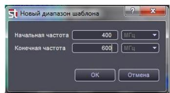
Созданный шаблон можно сохранить и впоследствии загрузить, используя кнопки "Загрузить..." и "Сохранить...". Загруженный шаблон отображается отдельным блоком в списке и отображается отдельным цветом на графике. Отдельные загруженные шаблоны можно включить или выключить галкой слева.
