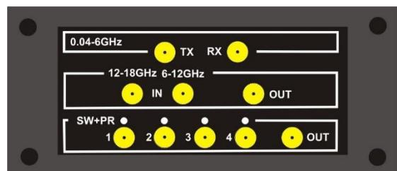
Базовым элементом является радиоприемный модуль с диапазоном частот 0.04 - 6ГГц.
