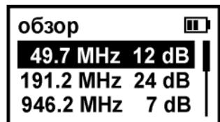
аналоговых сигналов, для которых невозможно достоверно определить значение частоты, отображается один, имеющий максимальный уровень. В конце списка находятся цифровые сигналы.
