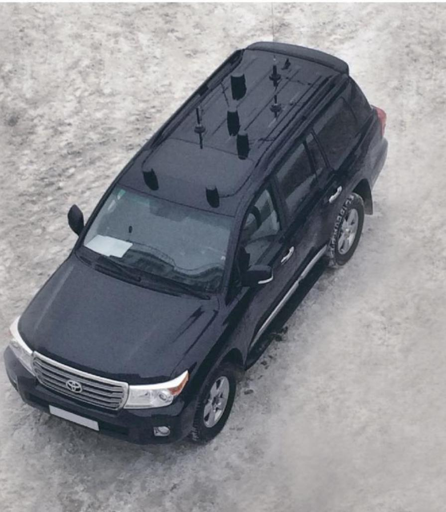
Изделие предназначено для защиты пассажиров автомобиля от несанкционированного прослушивания с помощью специальных радиоустройств и предотвращения срабатывания радиоуправляемых взрывных устройств (РВУ). Используется в условиях, когда необходимо подавление сигналов высокой мощности в расширенном диапазоне частот, а также требуется повышение эффективности защиты в диапазонах сотовой связи.
