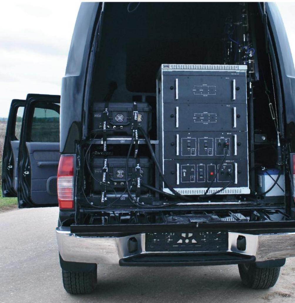
Изделие предназначено для защиты от радиоуправляемых взрывных устройств и для предотвращения утечки информации по каналам связи GSM900/1800, 3G, 4G при мощном сигнале базовых станций сотовых операторов в условиях плотной городской застройки. Применяется для обеспечения безопасности в местах массового скопления людей.
