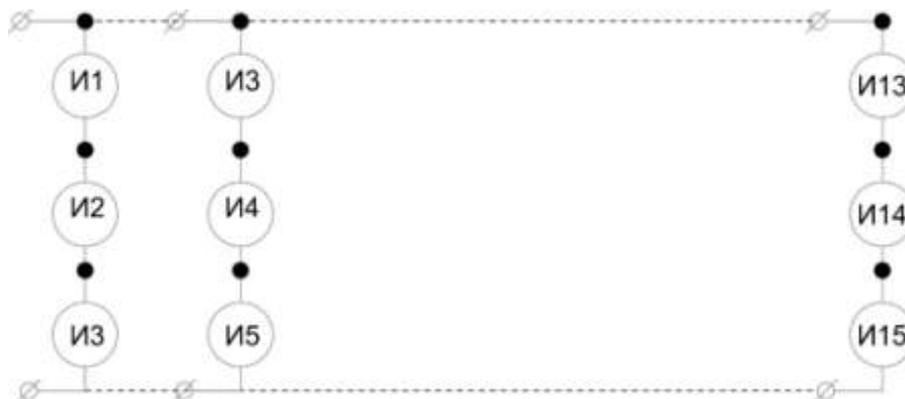
До 15 преобразователей на выход (по 3 преобразователя в одном блоке)
