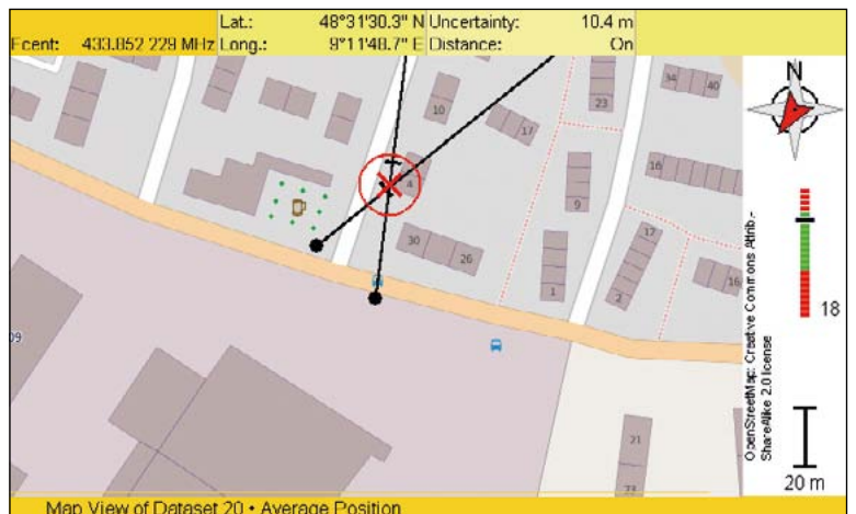
Рис. 6: Локализация с помощью триангуляции на сохраненном в приборе плане города.
